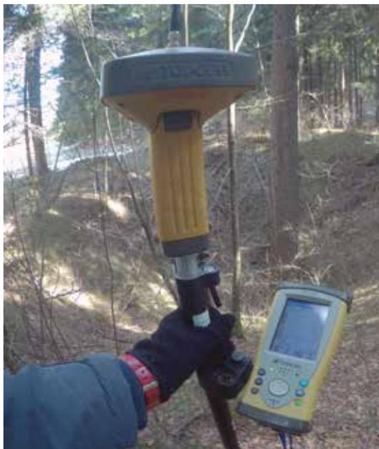
*Attività di rilievo con strumentazione GPS*
